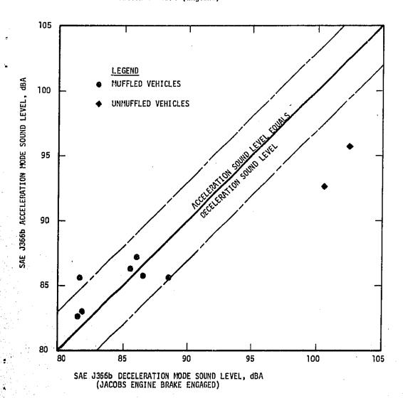
Figure 1 - ACCELERATION MODE SOUND LEVELS VERSUS DECELERATION MODE (WITH ENGINE BRAKE) SOUND LEVELS (SAEJ366b TESTS) FOR HEAVY TRUCKS
